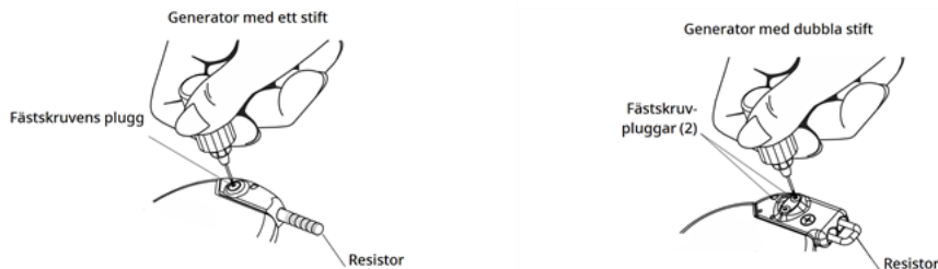
Bild 40. Anslutning av resistorenhet för generatorer med ett och två uttag
