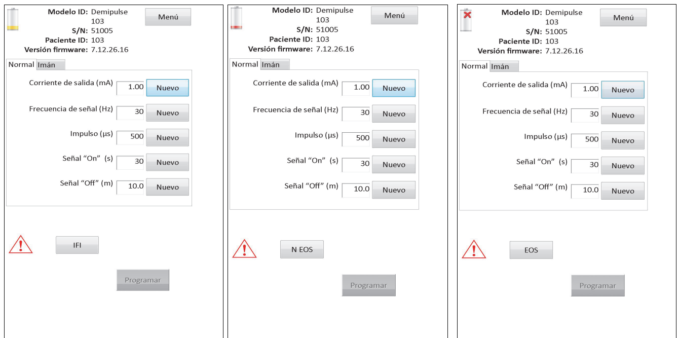
Figure 6. Pantalla PARÁMETROS con INDICADOR DE ESTADO DE LA BATERÍA ACTIVO
